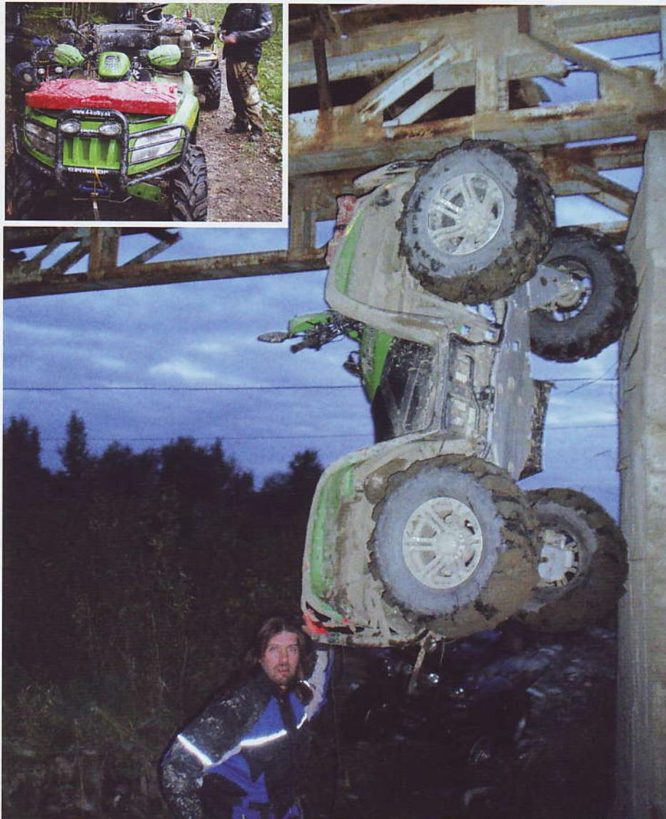
riadiidlá štvorkolky. Zásuvku káblového diaľkového ovládača sme umiestnili v zadnej časti. Nasledoval test, pri ktorom sme lano uviazali na konštrukciu mosta vo výške cca. 6 m a pomocou tohto kábla ovládača sme štvorkolku vytiahli až úplne hore pod most. Navijak TERRA 45 má fažnú silu vyše dvoch ton a preto si s týmto testom poradil s úplnou ľahkosťou.
