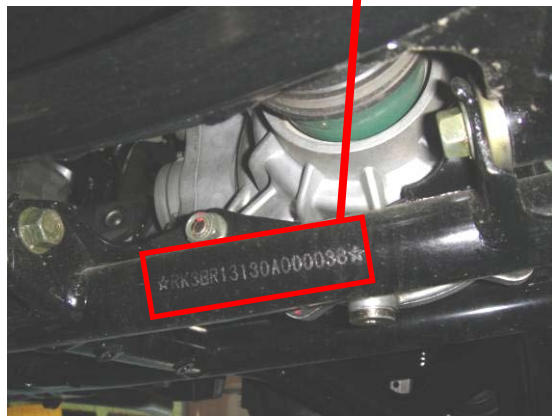
Umístění čísla VIN (Vehicle Identification Number)
