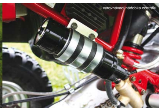
přední tlumič s progresivním pružením
