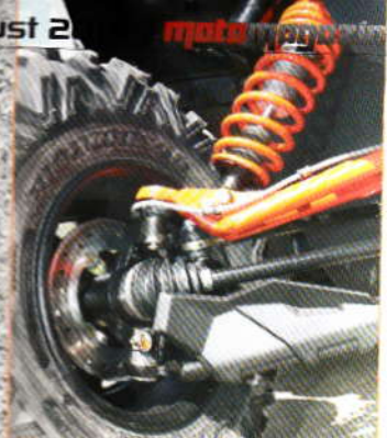
▲ FOX Podium X 2,0 X Performance HPG - zdvih 35,6 cm s nastavením útlmu i predpätia
