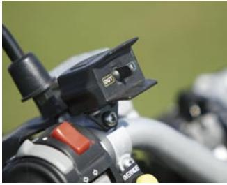
Užitočnosť Target-u môže zvýšiť aj naviják s ovládaním na riadiidlach.
