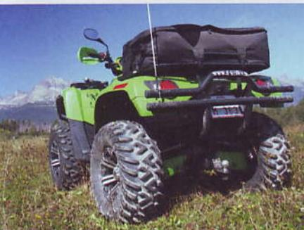
vený automatickou prevodovkou Duramatic, ktorá zabezpečuje dostatočnú trakciu a plynulosť jazdy i pri prudšom pridaní či ubratí plynu. Motorová brzda pracuje spoľahlivo a ubrzdí štvorkolku aj pri prudších zjazdoch bez použitia brzdi. Štvorkolka disponuje výkonným hydraulickým brzdovým systémom, ktorý je rozvádzaný značkovými SteelFlex hadičkami pre ešte väčší brzdný účinok.
