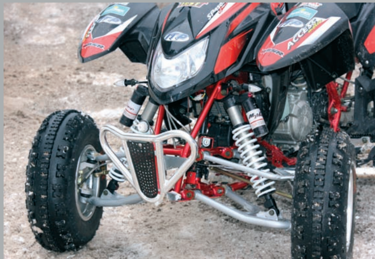
● Komponenty pruženia z dielne Accessu sú plne nastaviteľné
