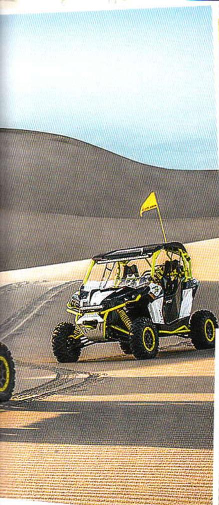
převodem řízení, samozřejmě s třímódovým posilovačem (DPSTM), novými 14palcovými beadlocky a 28palcovými Bighorny 2.o. Další výbava je jasná – imobilizér D.E.S.S. sedvěma klíči (jeden je omezený na rychlost 70 km/h, s druhým jede Maverick naplno), silnější 625wattové magneto umožňující montáž světelných ramp – už v základu má X ds 240wattové projektorové světlomety, digitálně-analogovou přístrojovku a samozřejmě automatický Visco-Lok QE+ přední diferák. Mavericka a Turbo X ds poznáte
