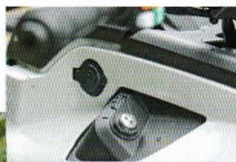
➤ **Nechýba 12V zásuvka napríklad pre pripojenie navigácie, vyhrievaného odevu, či doplnkového osvetlenia.**
