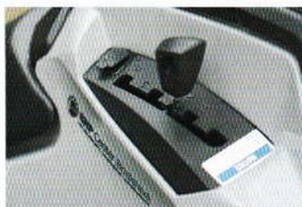
➤ **Prevody sú osvedčená klasika – rýchly a redukovaný dopredu, späť a parkovacia poloha. Nechýba možnosť zamknutia radiacej páky kľúčom (pod plastovou krytkou pri polohe P).**
