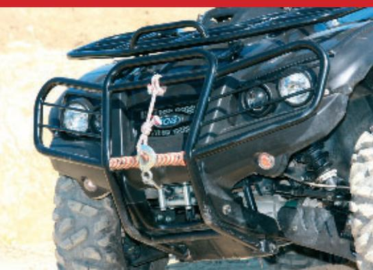
● Testovaná verzia bola vybavená elektrickým navijakom, ktorý potiahne až 1000 kg
